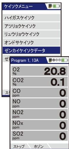
計測中に [ESC キー] で計測を中断した後に、前回中断時の計測値を見ることができます。
