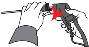
④ネジを時計回りに回します。最後までしっかりネジを回してください。ネジの締めがゆるい場合、漏れが起り、正しく計測できない場合があります。
