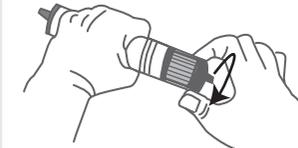
ホースを取り外してから、ドレンポットのジョイント部を回し、スターフィルターを取り外します。
