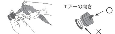
必ず、ホース取り付けジョイントからエアを吹いて下さい。フィルターに直接吹くと、フィルター内部に異物が入ってしまいます。その異物やスが計測器側に入ると、吸引異常などを引き起こします。
