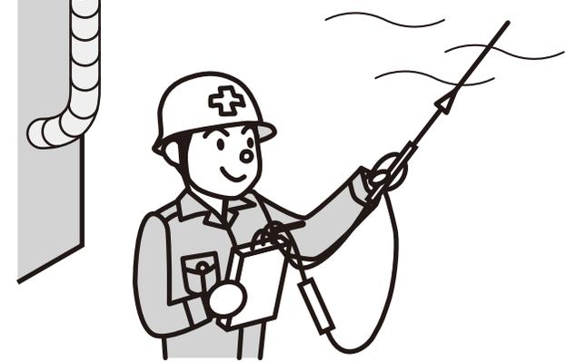
プローブを計測口から出し、大気を吸わせませす。排ガス画面の値が正常値に戻ったことを確認します。
