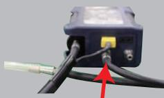
※プローブチューブ HT-7231 をご使用の場合は、テストキャップを使用せずにプローブの先端を直接ホースにつないでください。
