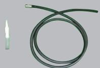
②プローブの先端にテストキャップ・ホースを取り付けます。
