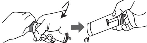
ジョイント部をねじって取り外し、内部にたまった水を取り除きます。水分除去後は、再び回しながらジョイントをはめ込んでください。
