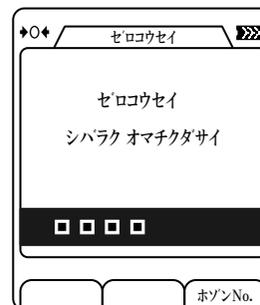
ゼロ校正には約 30 秒掛かります。ゼロ校正中は画面の左上に校正中のマークが表示されます。
