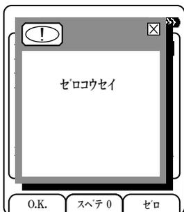
**注意** 圧力センサのゼロ校正は必ず、大気中で行って下さい。圧力をかけた状態でゼロ校正を行うと、数値が異常値を示します。
