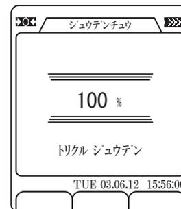
\*トリクル充電：充電電流を微小電流に切替え、自己放電分を補う充電方式
