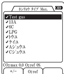
左端にチェックの入った燃料のみ燃料選択画面に表示されます。
