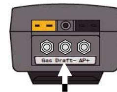
ドラフト計測の際はDraftのポートに圧力ホースを取り付けて下さい。
